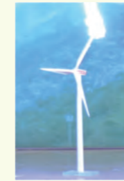
風力発電機モデルへの落雷実験
