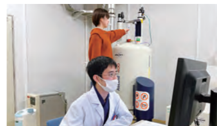
核磁気共鳴装置 (強力な磁場を利用して、物質中の分子の構造や状態を解明する)
